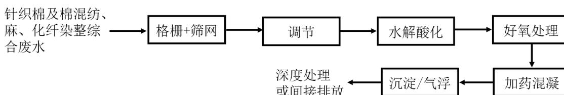
图 4 针织棉及棉混纺染整、麻染整以及化纤染整的综合废水常规处理工艺流程图
